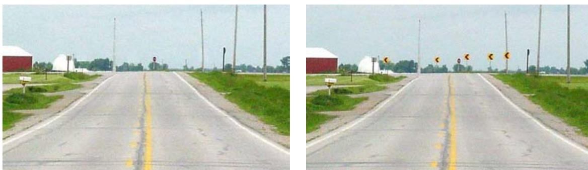
El espaciamiento recomendado debe ser tal que permita a los conductores ver por lo menos tres señales hasta que el cambio de alineamiento elimine la necesidad de las señales. La separación del borde de calzada es generalmente entre 1,5 y 2 m.
