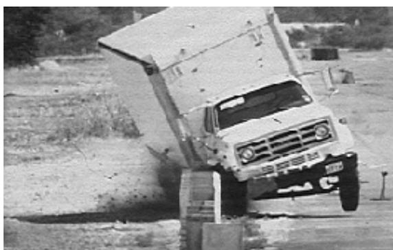
Cuando el ancho de trabajo sea mayor que la distancia a un objeto fijo, como pilas de puente, postes, se deberá utilizar una barrera de mayor rigidez que minimice la invasión por inclinación y por deflexión (menor ancho de trabajo).
