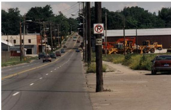
En general, el peligro crece con el flujo de tránsito, la densidad de postes (número de postes por longitud de camino), y de la separación desde el borde de calzada, y es mayor para postes en el lado exterior de las curvas horizontales, y en los lugares donde la fricción neumático-pavimento es reducida.
