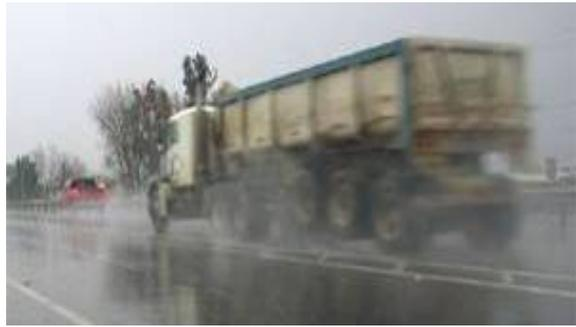
El agua tiene poco efecto sobre la fricción neumático-pavimento cuando los vehículos viajan a bajas velocidades, pero al aumentar la velocidad no se puede expulsar el agua y se pierde el contacto entre neumático y pavimento. La macrotextura provee canales para drenar el agua.
