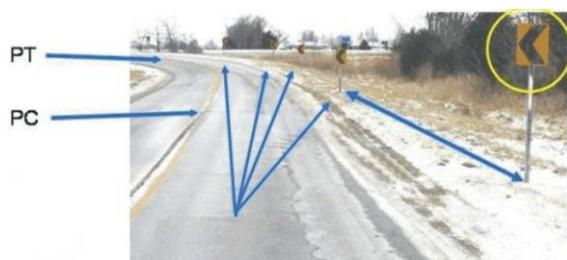
A menudo, los chebrones se introducen como parte de un paquete de medidas de delineación, y es difícil aislar sus efectos, pero se hallaron reducciones estadísticamente significativas en accidentes. Los conductores reaccionan favorablemente a los chebrones en las curvas cerradas, y proveen mejor información de largo-rango en tales curvas que los postes guías.
